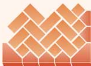
Verlegung mit Bischofsmützen
