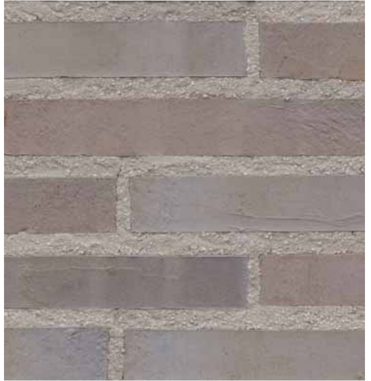
36102 aquaterra Vesuvgrau 365 x 115 x 52 mm Fugmörtel + heller Splitt, Körnung 1,8–3 mm
